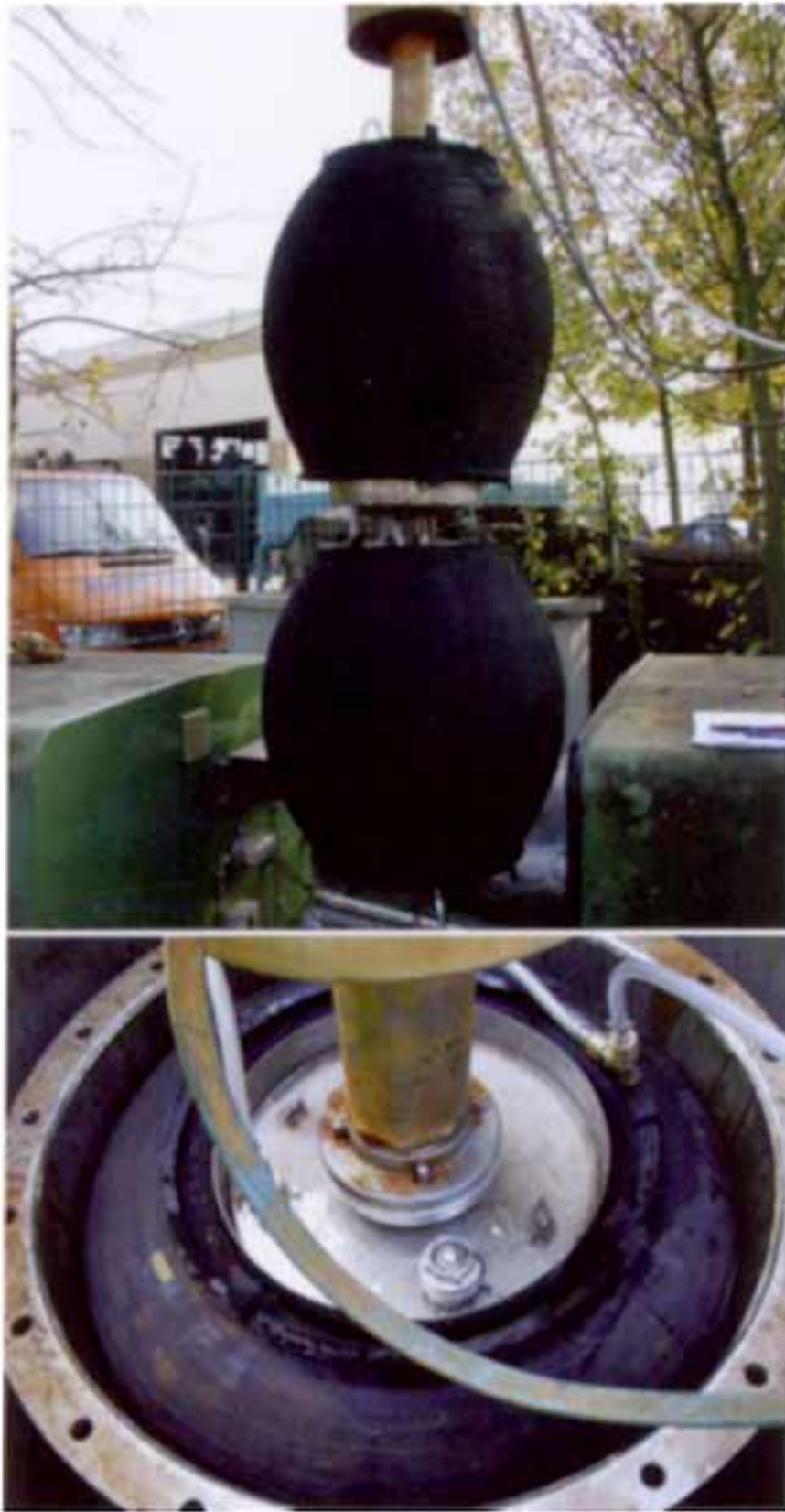
Abb. 7: Symmetrische Doppelkolbenkammer (oben) für den Einsatz in Vertikalfilterbrunnen DN 750 zur Intensiventnahme und Anpresstest zur Prüfung der Formstabilität (unten)
