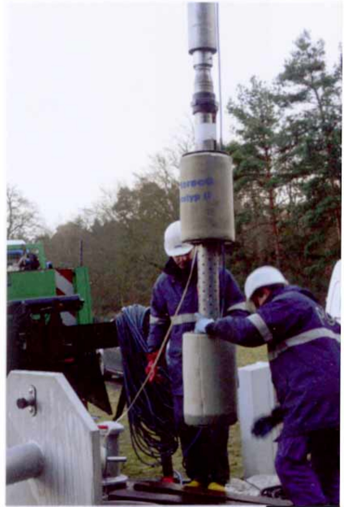
Abb. 8: Symmetrische Doppelkolbenkammer in der Version Prototyp II für den Einsatz in Vertikalfilterbrunnen DN 300 zur Intensiventnahme mit gemantelter Tauchmotorpumpe am Brunnen 10 Rathenow
